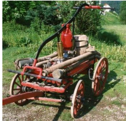
Pumpe auf Pferdewagen
